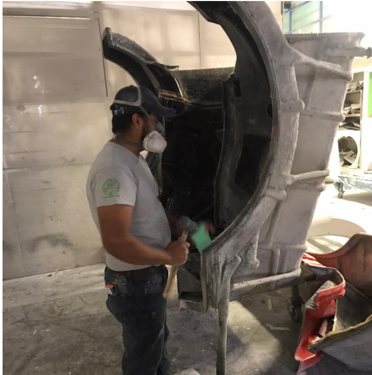
Figura 12: Desmoldado, línea 1 Fuente: CVNS INDUSTRIAS S.A de C.V
